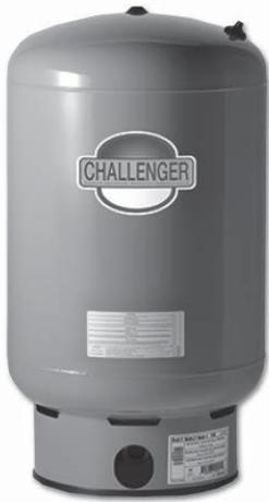
Los Tanques precargados Challenger® con tecnología de diafragma CAD2, están contruidos en acero solido calibre 16. Diseñado pensando en las necesidades de los contratistas con calidad Flexcon y rendimiento a un precio competitivo. Cada tanque se somete a pruebas de costura, alta presion y helio, para detectar fugas de aire. Una prueba final de aire asegura que cada tanque llegue con una pre-carga correcta. Sus principales materiales y características son:
